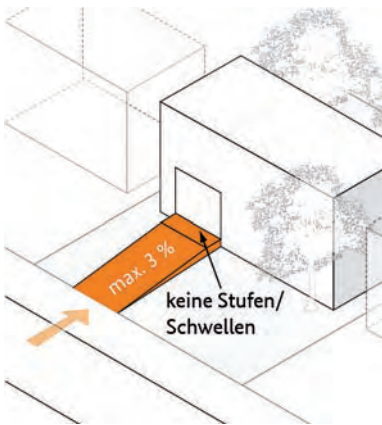
Topographische Situation zur barrierefreien Erreichbarkeit von Eingängen
